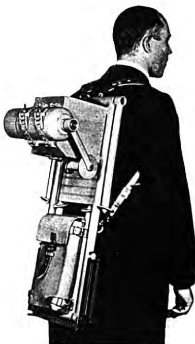
Bild 8. Transport des Handdrehgenerators.
