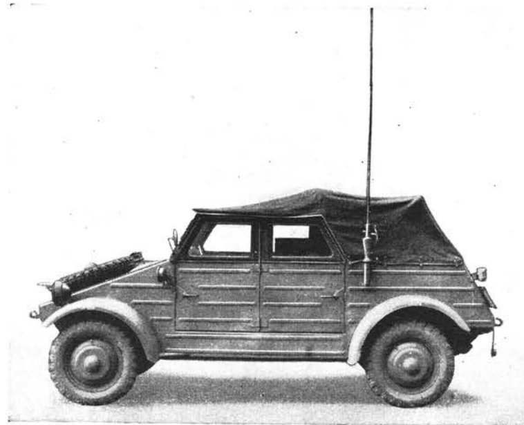
Der Funkkraftwagen (Kfz. 2) mit Fahrzeugstabantenne
