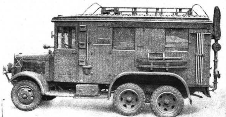
Außenansicht des Funkkraftwagens (Kfz. 61)
