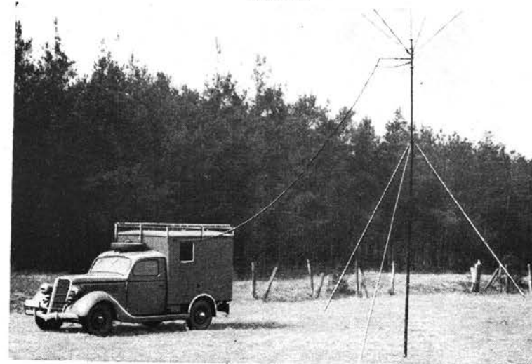
Behelfsmäßig eingerichteter handelsüblicher Kraftwagen (unter 1 t) — Beladung eines fl. Fu. Tr. b usw. (mot.) betriebmäßig mit abgesehtem 5-m-Stedmast und Sternantenne a aufgebaut —
