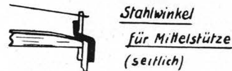
Behelfs-Dachantenne für geschlossenen Lkw.-Aufbau (Befestigung der seitlichen Mittelstützen)
