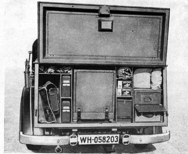
Handelsüblicher f. Pkw. mit behelfsmäßiger Einrichtung als Ersatz für Funkkraftwagen (Kfz. 15) Gerätkasten geöffnet
