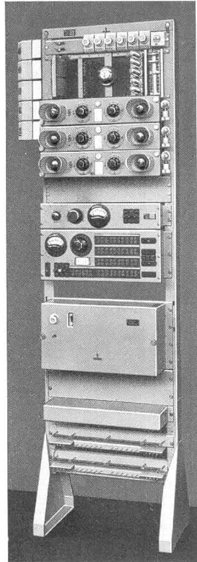
mit drei Verstärkern Rel Sk I A 42/5
