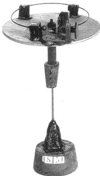
Abb. 1. Kreisförmiger Resonator von Heinrich Hertz (Deutsches Museum, München).
