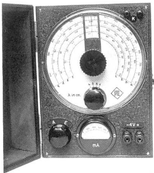
Abb. 250. Ansicht eines Wellenmessers nach dem Schema der Abb. 249 für einen Wellenbereich von 30–550 cm aus dem Physikalisch-Technischen Entwicklungslaboratorium, München.
