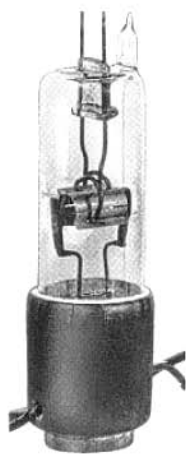
Abb. 336. Vierteilige Habann-Röhre der Telefunken-Gesellschaft für \lambda = 50 cm und 60 W.
