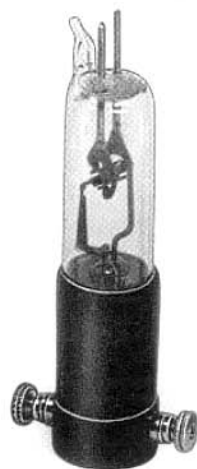
Abb. 360. Vierteilige Habann-Röhre mit 0,22 cm Anodendurchmesser (Telefunken).
