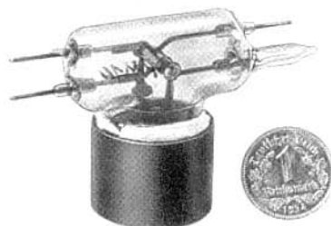
Abb. 338. Zweiteilige Habann-Röhre der Telefunken-Gesellschaft mit durchgehenden Lecher-Drähten für \lambda = 10 cm und 0,5 W.
