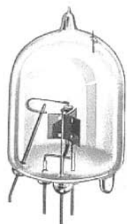
Abb. 83. 149-Y-Dezimeter-röhre der Western Electric.
