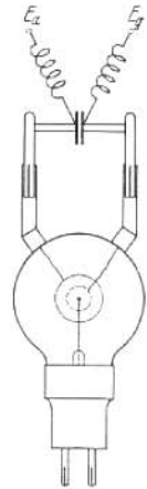
Abb. 102. Ultrakurzwellensender für \lambda = 82 cm.
