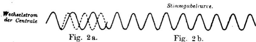
Fig. 2 a giebt die Schwingungsform des Wechselstromes der Strassburger Centrale (50 ganze Schwingungen pro Secunde). Der Strom wurde nach Abschwächung auf ein halbes Ampère (mittels vorgeschalteter Glühlampe) durch eine Spirale von 50 mm Länge, 22 mm äusserem, 10 mm innerem Durchmesser
